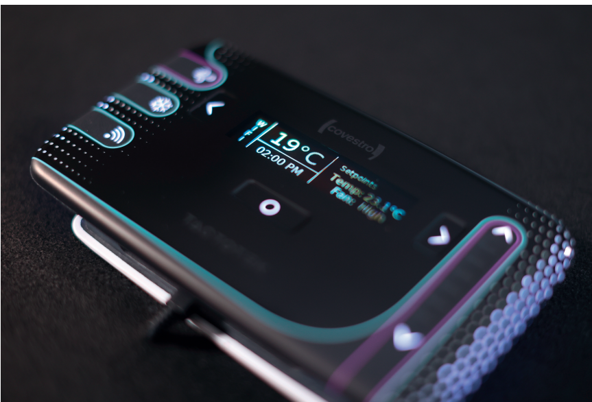
Bild 5. Folientechnik macht es möglich: Der Nighthawk-Demonstrator von TactoTek und Covestro enthält Touch-Funktionen, ein Display und Beleuchtungselemente und ist dabei nur 3,5 mm dick.
