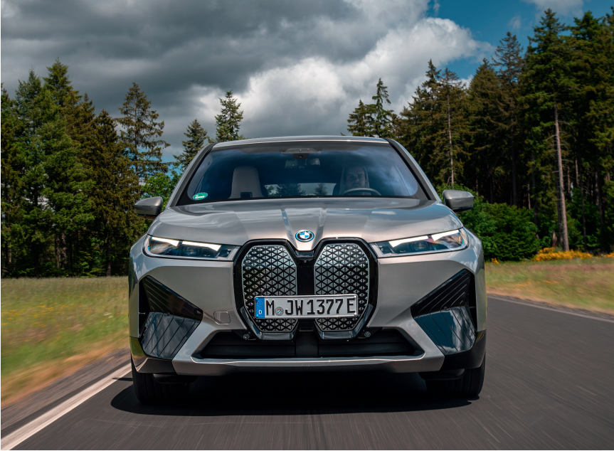
Bild 4. Das markante Frontpanel für den BMW iX wird aus Makrolon AG gefertigt. Kameratechnik, Radarfunktionen und weitere Sensorik für das Fahrerassistenzsystem sind elegant in das großflächige Bauteil integriert. © BMW
